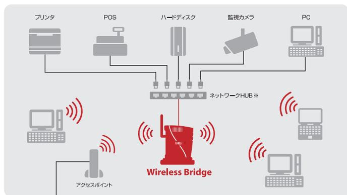
※市販のネットワークHUBを使用すれば最大16台のデバイスを無線LAN対応できます。
